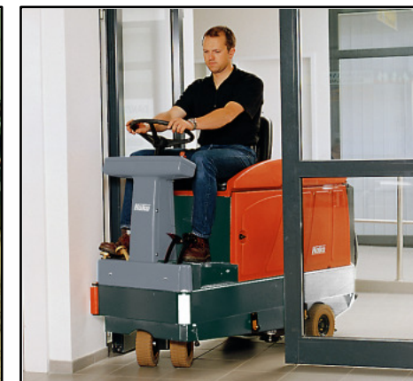
La pulizia di bordi e perimetri non è un problema, grazie alle spazzole protendenti e al tergilavaggio oscillante.
